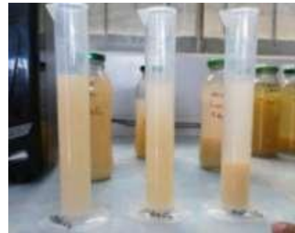
Fotografía 20: Proceso de sedimentación
