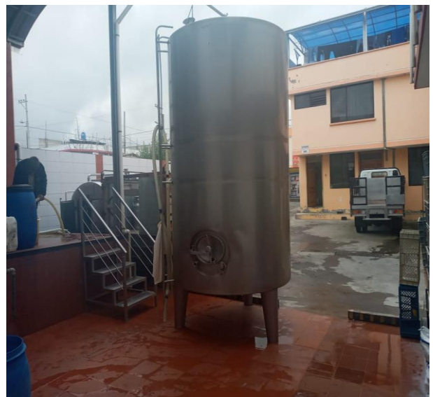
Fotografía 8. Tanque de almacenamiento de suero Lácteo
