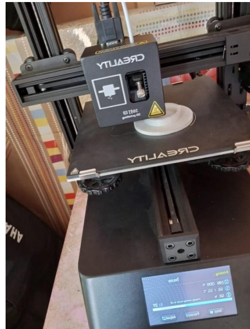
foto 4: imprimiendo base de engranaje
