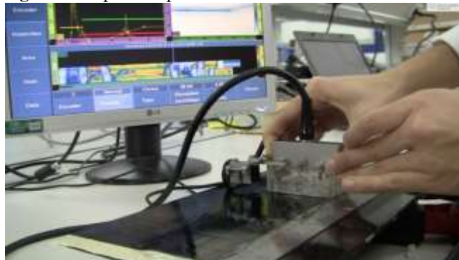
Figura 5. Inspección por Ultrasonido.
