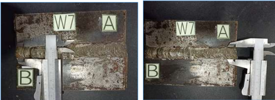
Figura 41. Medición del ancho del cordón de la probeta W7
