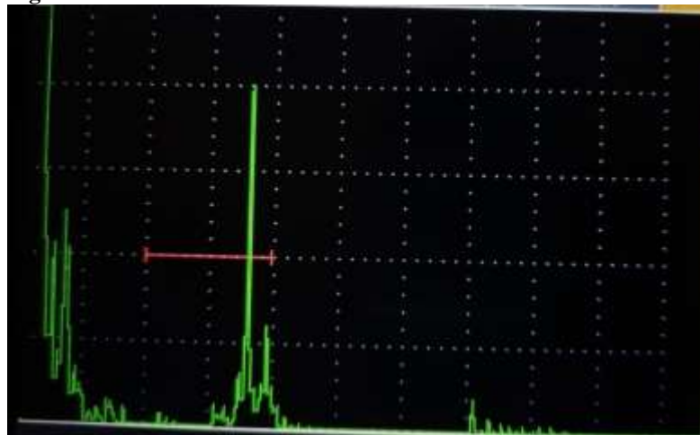
Figura 65. Nivel de indicación de la discontinuidad en W6-B
