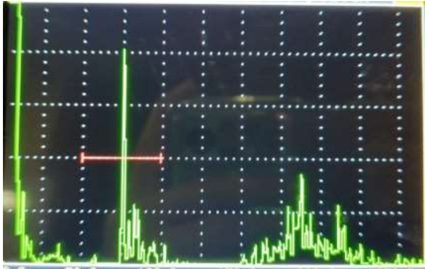
Figura 55. Nivel de indicación de la discontinuidad en W1-A
