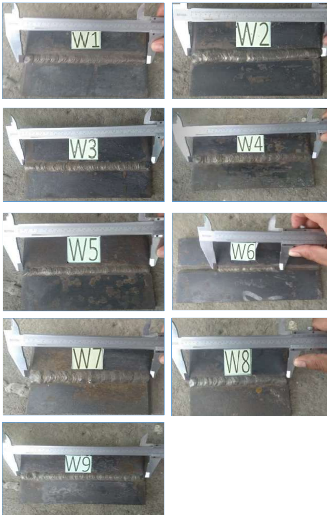
Figura 44. Mediciones de longitud de cordón desde w1 - w9
