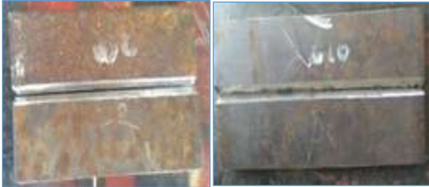
Figura 28. Placas preparadas de 150 x 100 x 8 mm y 190 x 100 x 8 mm
