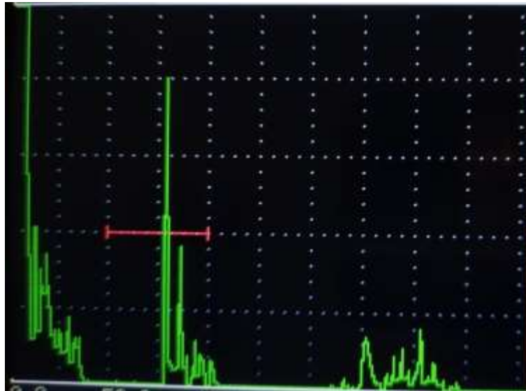
Figura 60. Nivel de indicación de la discontinuidad en W5-A
