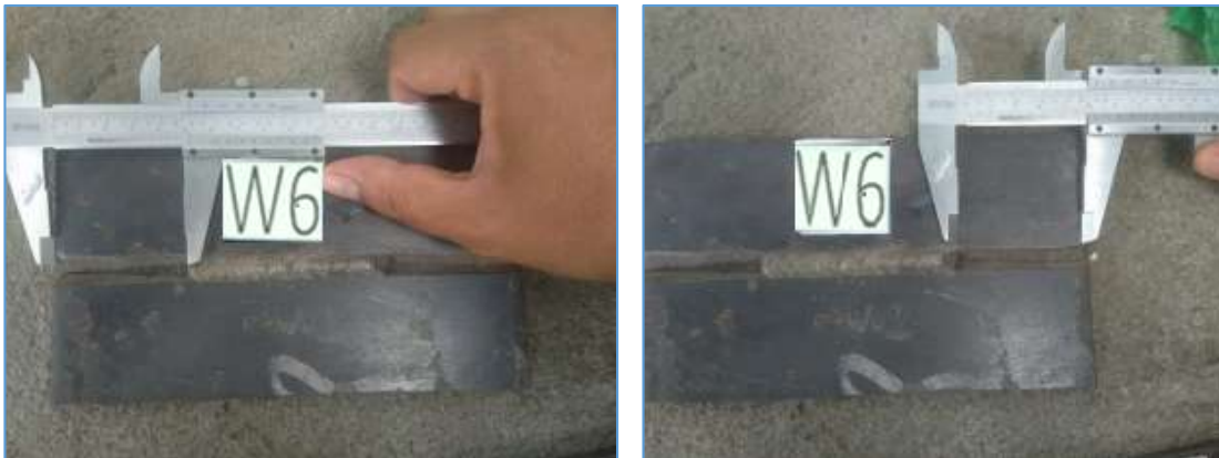
Figura 45. Mediciones de falta de fusión en cordones de soldadura
