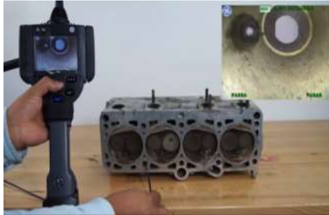
Figura 4. Inspección visual indirecta o remota en el monoblock de un motor.
