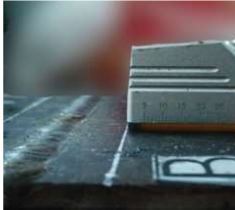
Figura 54. Inspección de la zona de barrido
