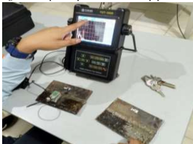
Figura 10. Inspección por ultrasonido con equipo Yut-2600
