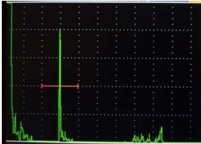
Figura 63. Nivel de indicación de una segunda discontinuidad en W5-B
