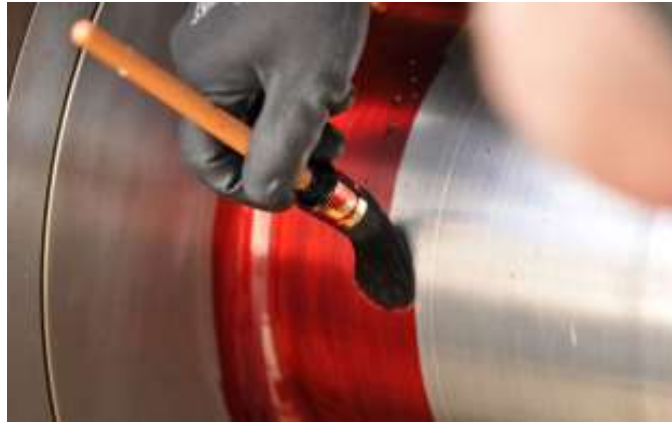
Figura 7. Inspección por Líquidos penetrantes (PT).
