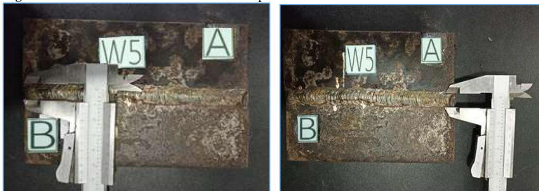
Figura 39. Medición del ancho del cordón de la probeta W5
