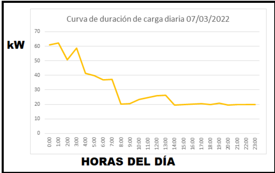
ANEXO 15. Curva de duración de la carga diaria del 06 de marzo del 2022.
