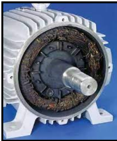
Figura 7. Falla en la protección eléctrica del cuadro de control del motor y avería del mismo.
