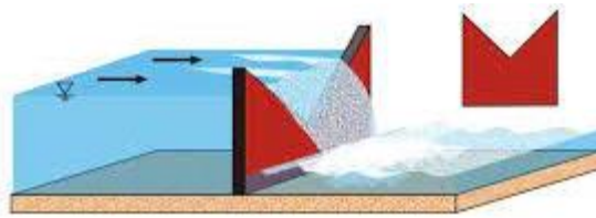
Figura 4. Vertederos de Cresta Delgada [16]
