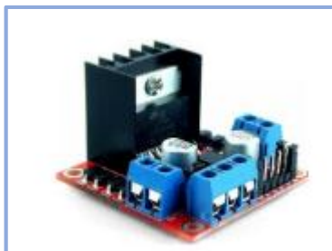
Figura 3.14: Módulo Puente H [22]
