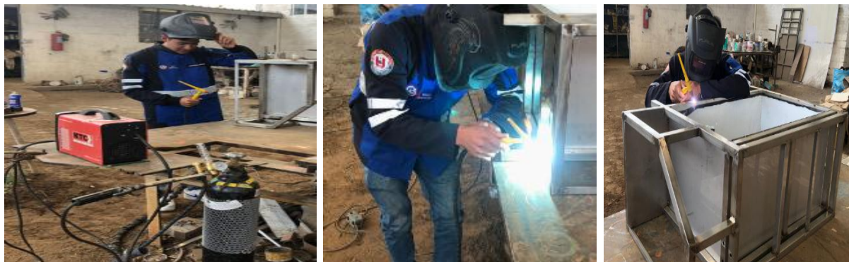
Figura III.3. Soldadura de la estructura
