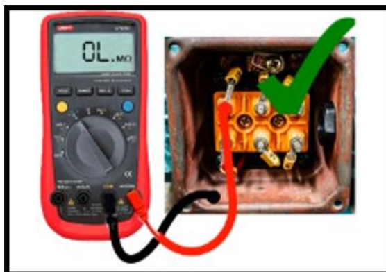
Figura 3.2 Medición del motor aterrizado a tierra
