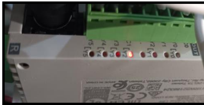
Anexo figura: 25 Comprobación del PLC de las señales digitales
