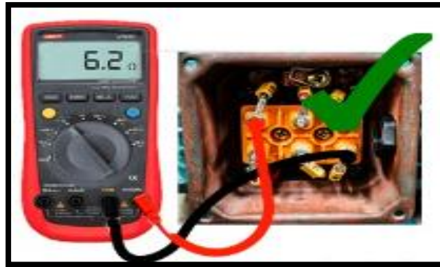
Figura 3.3 Medición de la bobina del motor
