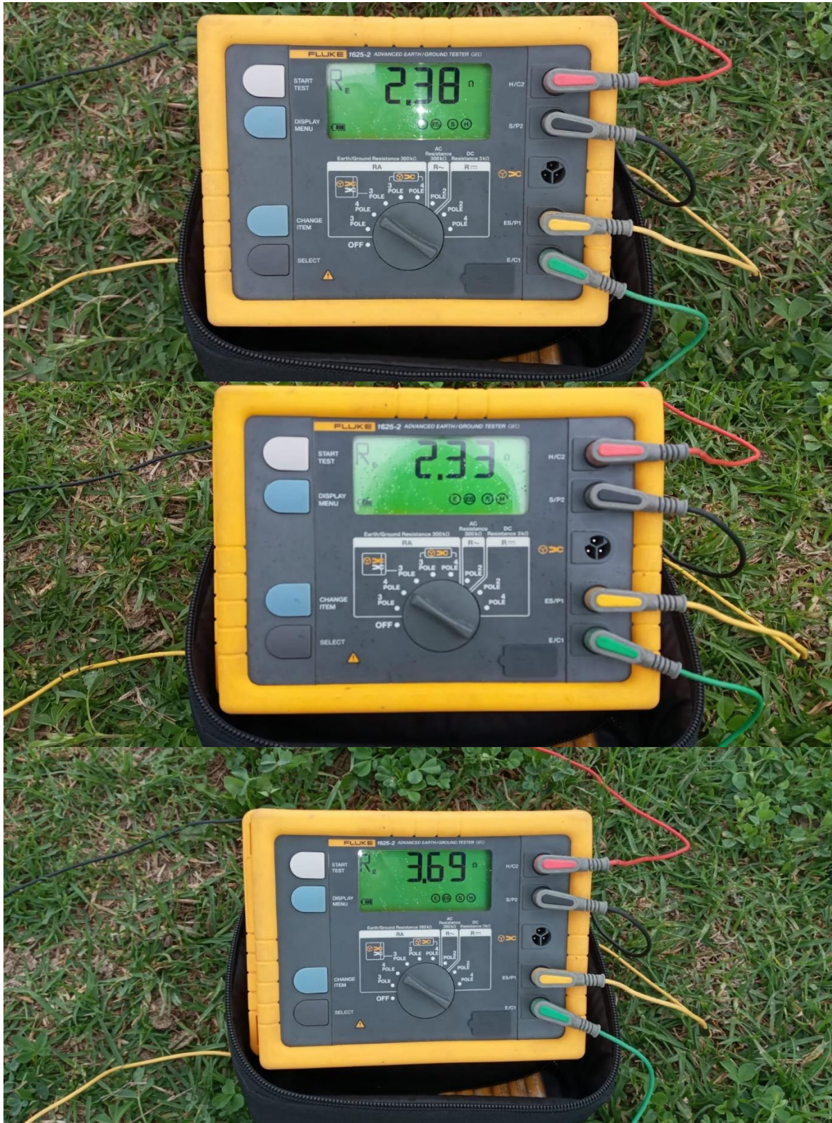
Imagen 18. Resistividad del terreno.
