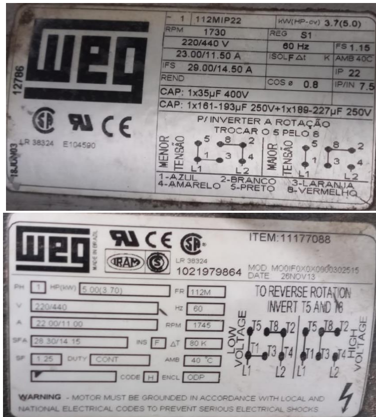
Imagen 10. Datos de las placas del motor.
