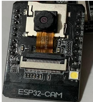
Figura 2.6 Placa prefabricada ESP32-CAM.
