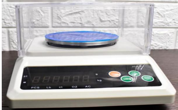
*Figura 29. Balanza de precisión*
