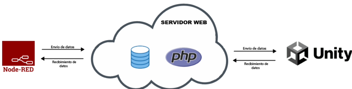
Figura 4.23 Comunicación NODE-RED a UNITY
