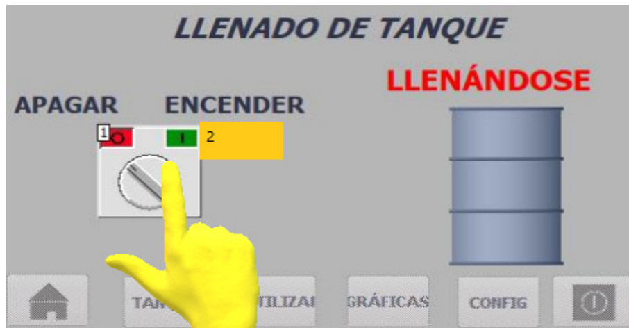
Anexo P.7. Encendido de llenado de tanque
