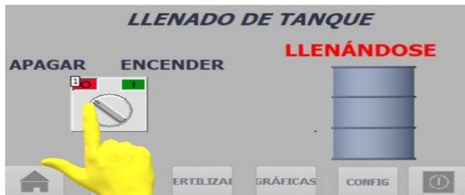
Anexo P.8. Desactivación de Llenado de Tanque
