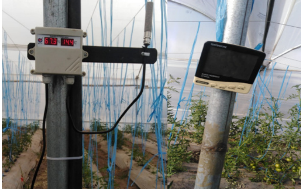
Anexo G.1. Colocación de Sensores para el control de temperatura
