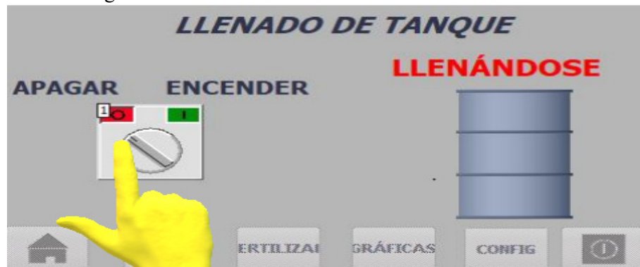
Anexo P.8. Desactivación de Llenado de Tanque
