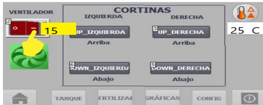
Anexo P.20. Activación de extractores
