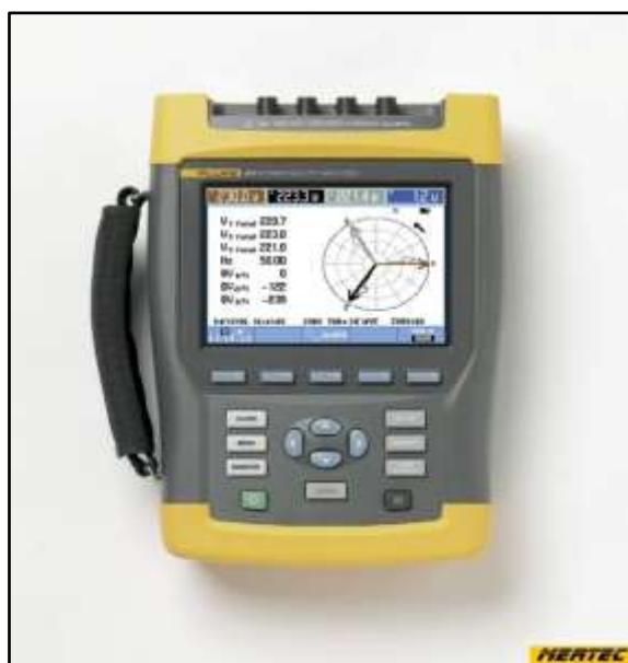
Figura 3. 3: Analizador de calidad eléctrica y energía.
