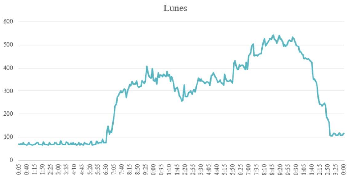
Figura 5. 8: Consumo de energía eléctrica lunes en el bloque "B" de la UTC.
