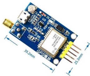
Figura 3. 7. Modulo GPS NEO 7M.[16]
