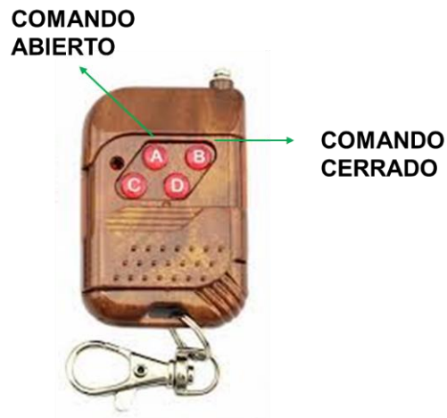
Figura 4. 9. Control de radiofrecuencia con sus comandos.
