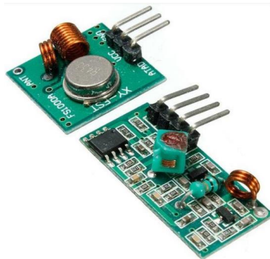
Figura 3. 8. Modulo transmisor RF 433 Mhz.
