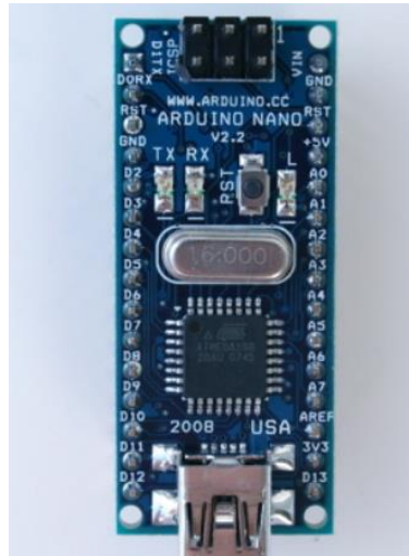
Figura 3. 9. Placa del Arduino Nano [17].
