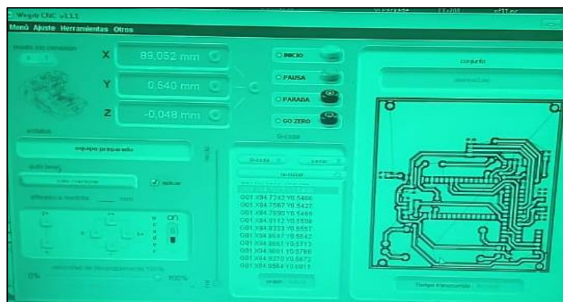
Figura 4. 16. Impresión del circuito en maquina CNC.
