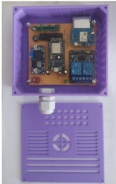
Figura 4. 20. Placa ubicada dentro de la caja de proyecto.
