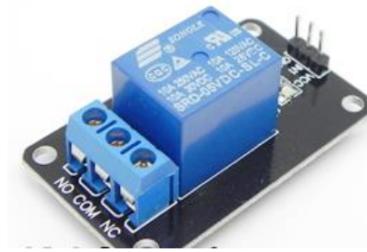
Figura 3. 5. Módulo de relé para Arduino [14].
