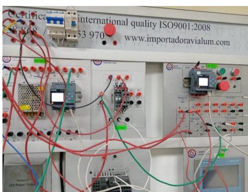
Figura 5.3. Prototipo 2 utilización de dos LOGO!. LOGO! maestro y esclavo.
