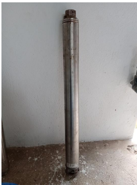
Figura 3.33. Motor de 5HP de bomba sumergible Franklin Electric.
