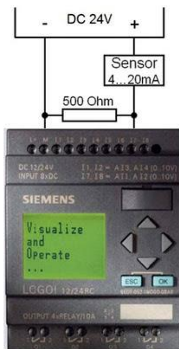
Figura 4.9. Conexión de un sensor de 2 hilos [64].
