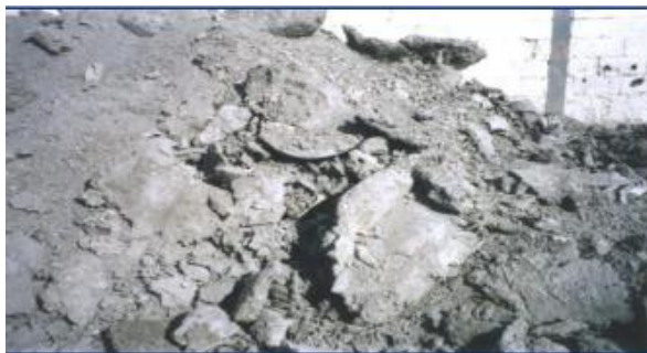
Figura 2.2: Escorias de fundición de aluminio [13]
