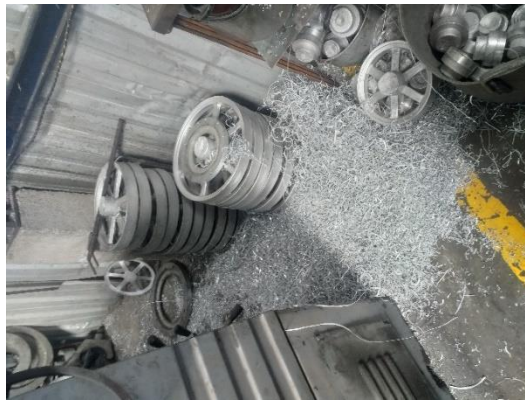
Figura 3.10: Residuos de mecanizado (viruta de aluminio)
