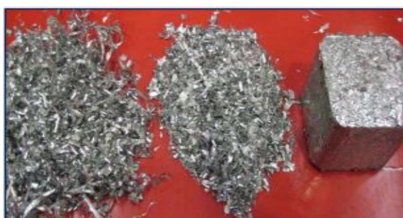
Figura 2.4: Viruta original, triturada, briquetada [16]
