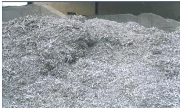
Figura 2.3: Viruta del área de mecanizado, piezas de aluminio [16]
