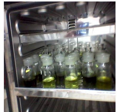
Evaporación de hexano en la estufa
