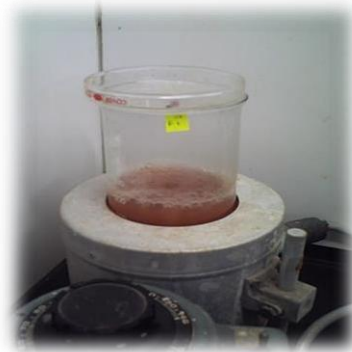
Digestión de muestra más hidróxido de sodio
