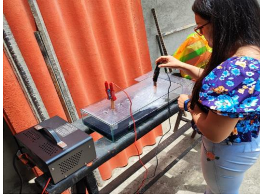
Fotografía 1. Diseño del tanque para electrolisis
