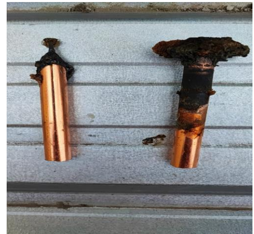
Anexo 10. Placas consumidas luego de la electrolisis
