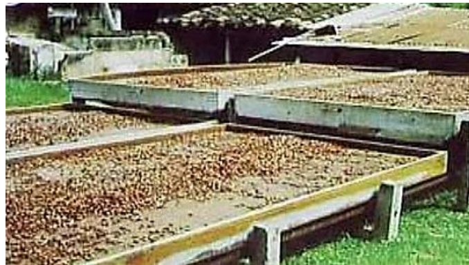
Figura 6. Secadero tipo Elba Fuente: (Jibaja Soria & Peñaherrera González, 2021)
