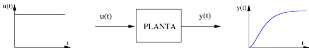
Fig. 9. Respuesta del sistema en lazo abierto ante entrada escalón unitario. [15]
