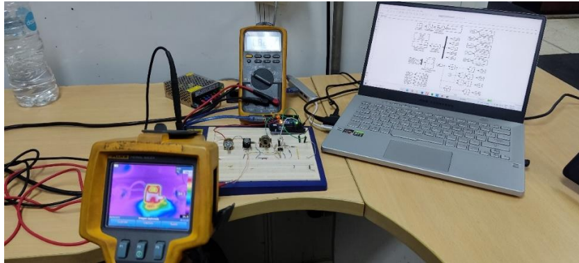
Fig. 44. Validación de medición y calibración de temperatura.
