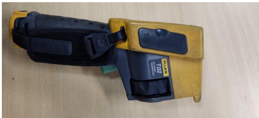
Fig. 45. Instrumento patrón: Cámara termográfica Fluke Ti32.
