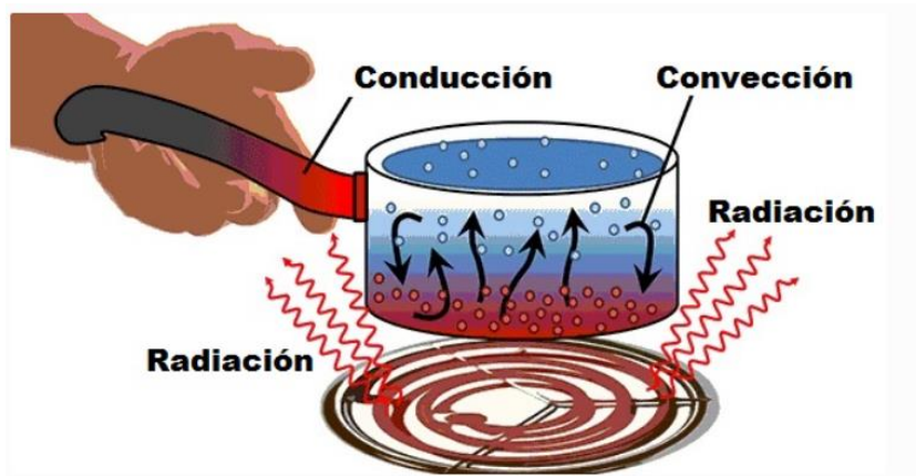
Fig. 19. Mecanismos de transferencia de calor. [24]
