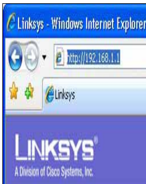
GRÁFICO N° 3.12: ACCESO A LA CONFIGURACIÓN EL RUTEADOR WRT54GL
