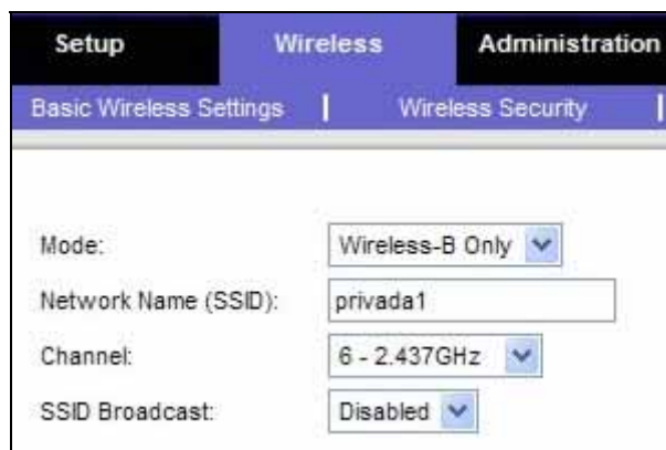
GRÁFICO N° 3.30: CONFIGURACIÓN WIRELESS DEL EQUIPO WAP54G
