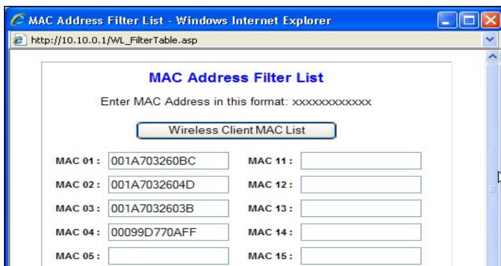
GRÁFICO N° 3.23: LISTA DE MAC ADDRESS PARA EL FILTRO DEL EQUIPO WRT54GL
