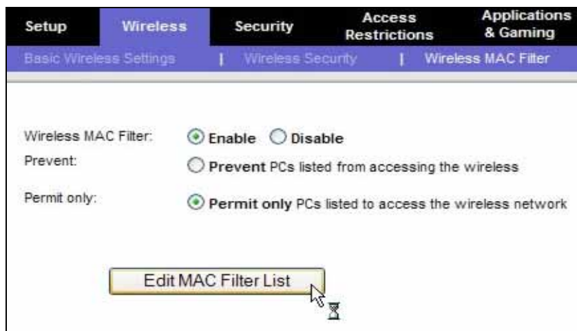
GRÁFICO N° 3.22: CONFIGURACIÓN DEL FILTRO MAC ADDRESS DEL EQUIPO WRT54GL.
