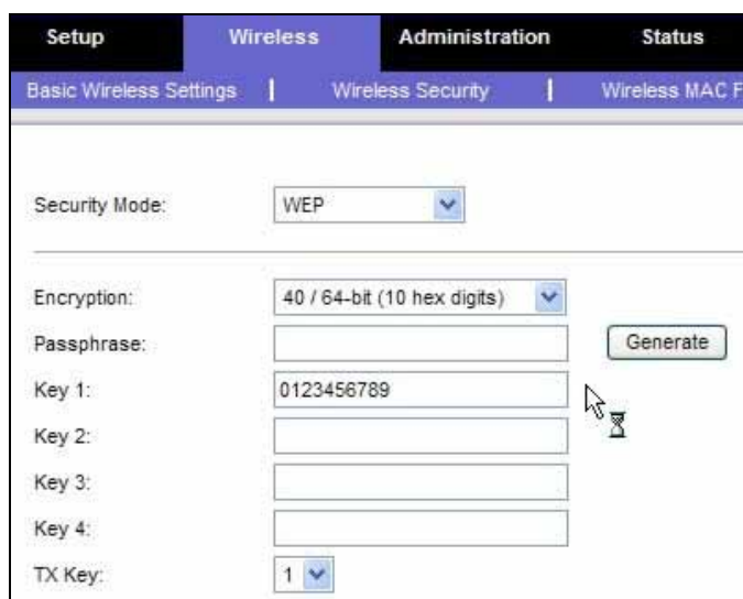
GRÁFICO N° 3.31: CONFIGURACIÓN DE SEGURIDAD WIRELESS DEL EQUIPO WRT54GL
