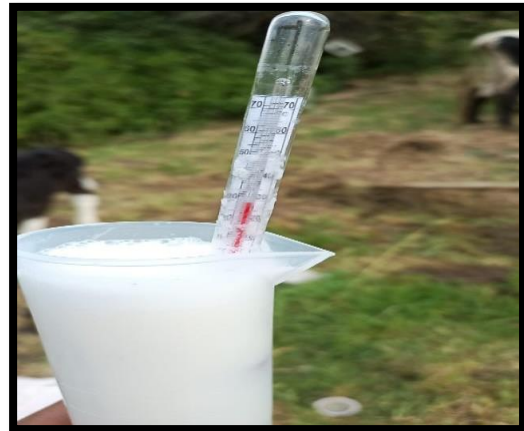
Anexo 4. Medición de densidad de leche con lactodensímetro y probeta de plástico.
