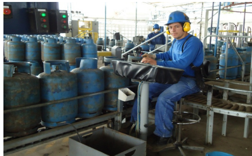
Figura 8: Selección de cilindros Fuente: Nave de Envasado de GLP Planta Ambato ENI-Ecuador
