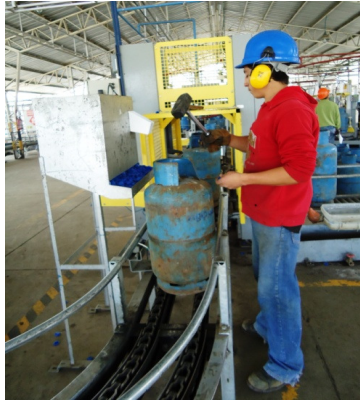
Figura 11: Colocación de tapas de seguridad Fuente: Nave de Envasado de GLP Planta Ambato ENI-Ecuador
