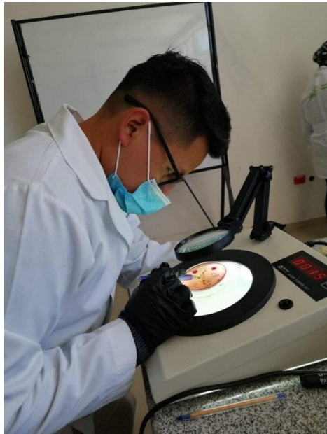
Fotografía 19: conteo de colonias para análisis de coliformes fecales.
