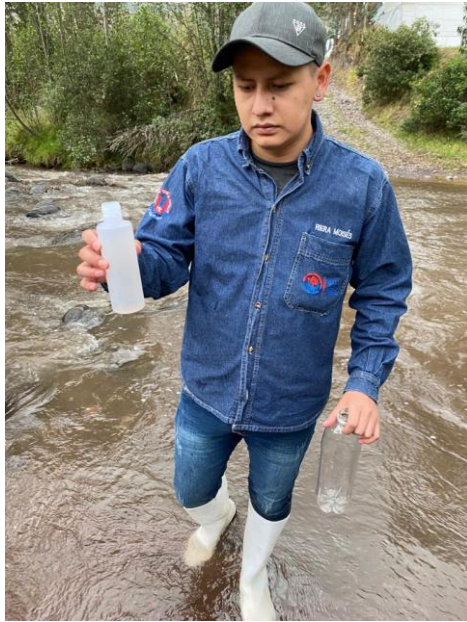
Fotografía 9: recolección de muestras para análisis de parámetros físicos , químicos y microbiológicos
