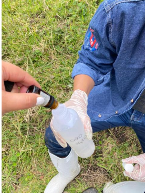
Fotografía 17: colocación de reactivo ( H_2SO_4 ) para análisis de parámetros físicos, químicos.
