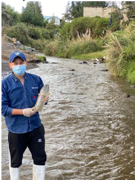
Fotografía 15: recolección de muestras para análisis de parámetros físicos , químicos y microbiológicos
