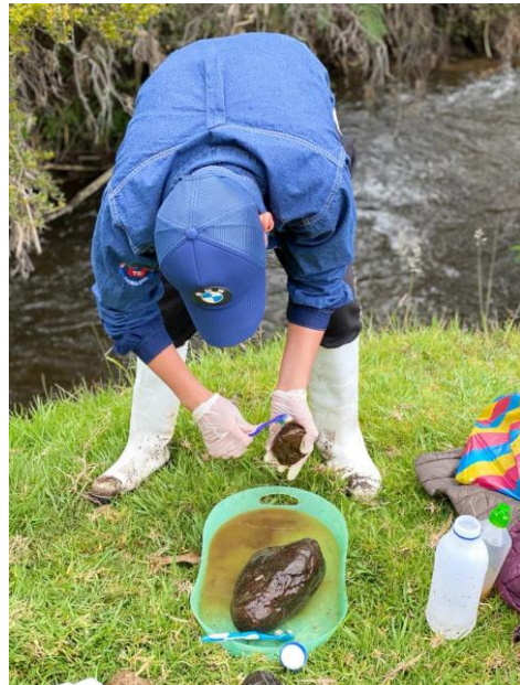
Fotografía 2: cepillado de rocas con agua destilada
