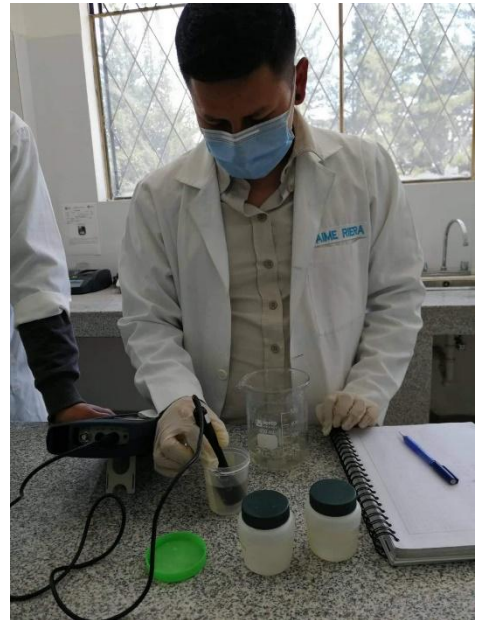
Fotografía 20: utilización de Multiparámetro con las muestras de agua del río Aláquez
