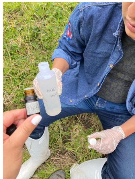
Fotografía 4: colocación de reactivo ( H_2SO_4 ) para análisis de parámetros físicos, químicos.
