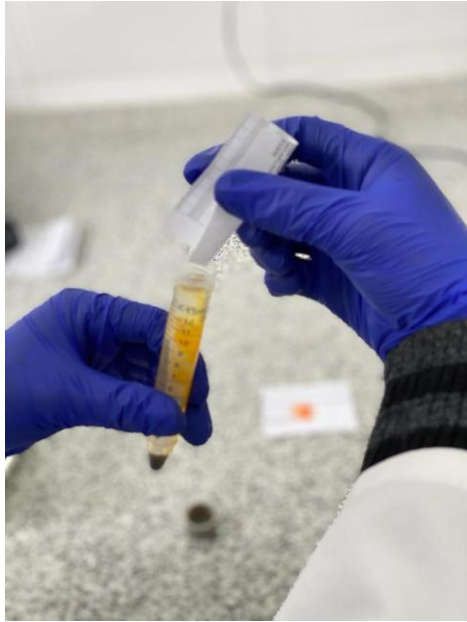
Fotografía 25: colocación de dicromato de potasio ( K_2Cr_2O_7 ) en cada tubo de ensayo
