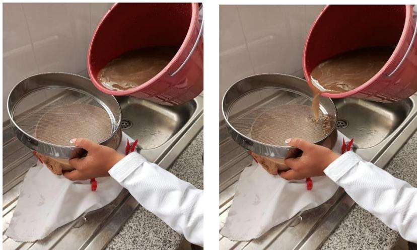
*Imagen 12 vaciamos el sobrante del tamiz a los tubos de centrifuga*
