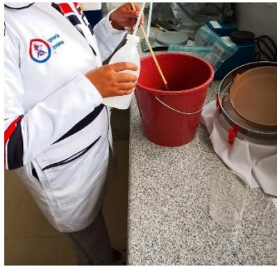
*Imagen 11 Vaciar la muestra sobre una malla de dos tamices uno sobre otro.*
