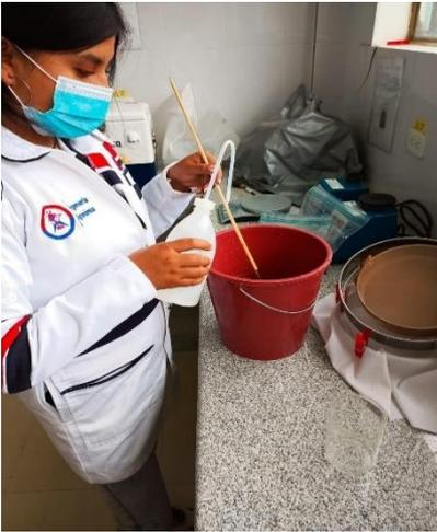
*Imagen 12 Vaciar la muestra sobre una malla de dos tamices uno sobre otro.*
