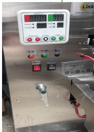
Ilustración 23: Panel de control de la empacadora
