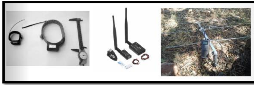
Ilustración 6: Equipos De Radio Telemetria (22)
