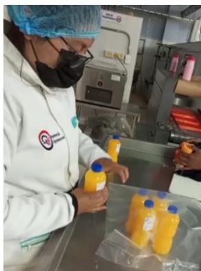
Ilustración 5. Recubrimiento con el material termoencogible
