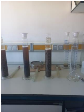
Fotografía 4. Densímetro de Bouyoucos a lado de los vasos de precipitación
