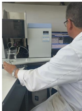
Fotografía 9. Calibración del espectrofotómetro y fotómetro de llama
