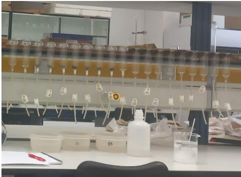
Fotografía 12. Preparación del lixiviado
