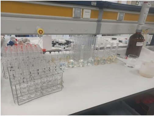
Imagen 11: Lixiviado para medir bases y CIC
