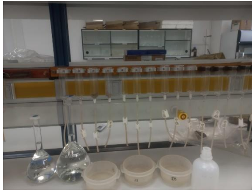
Fotografía 7. Embudos de percolación con las muestras de suelo.
