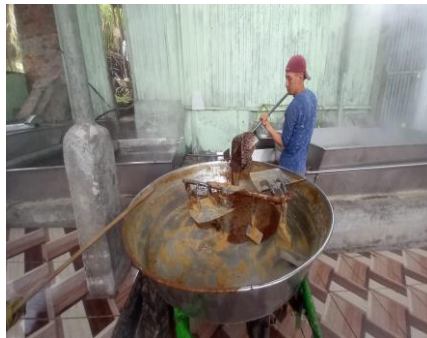
Fotografía 17. Operario sin un adecuado EPP.
