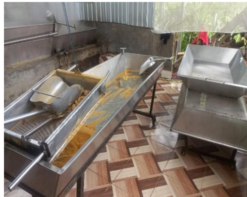
Ilustración 6. Pisos de trapiche recubiertos con baldosas.
