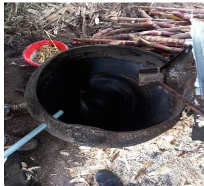
Fotografía 15. Paila de caucho utilizado como prelimpiador.
