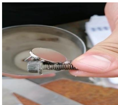
Fotografía 18. Pruebas realizadas con imanes de neodimio.
