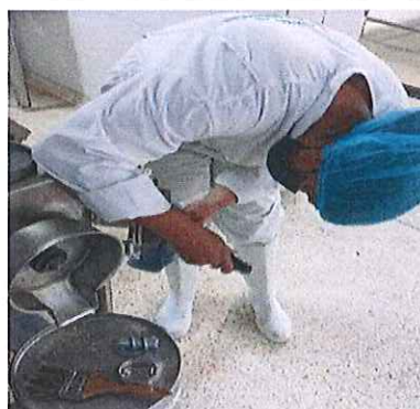
Anexo 4. Desajuste de seguros y tornillos y discos del molino pulverizador de granos.
