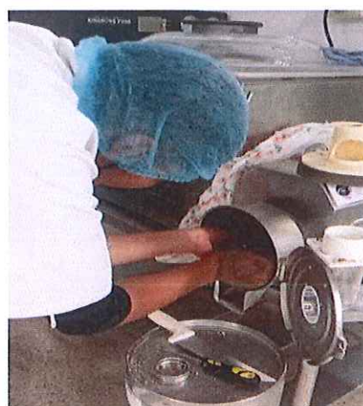
Anexo 2. Colocación de discos de piedra para pulverización.
