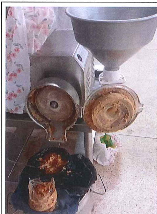
Anexo 5. Obtención del producto restante en los discos de piedra y cámara de molienda.
