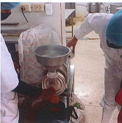
Anexo 3. Calibración de la perilla de ajuste de espesor a nivel de molido.
