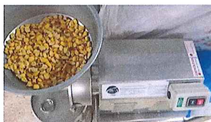
Anexo 2. Grano de maíz seco dentro de la tolva para ajuste de calibración.
