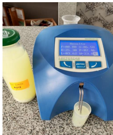
Fotografía 1. Equipo de análisis proteína y lactosa “lactoscan”
