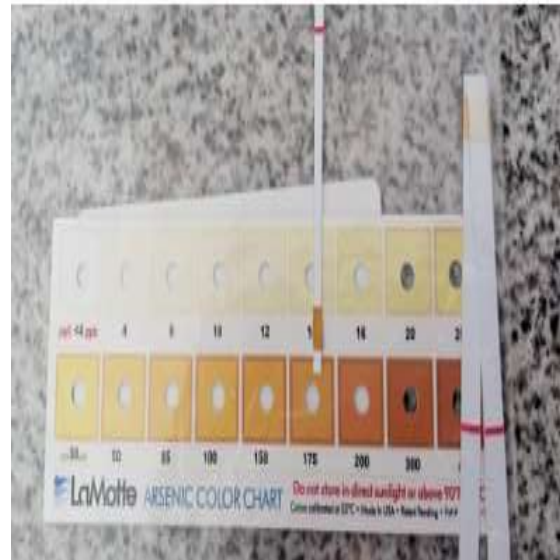
Ilustración 17. Resultado de Tira reactiva del suelo sin contaminar.
