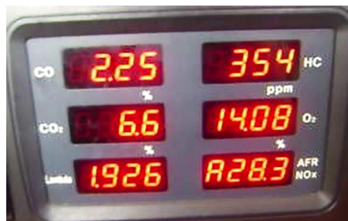
Figura 4.15. Pantalla del analizador de gases utilizado para gases de combustión y corroborar la tabla 4.17.
