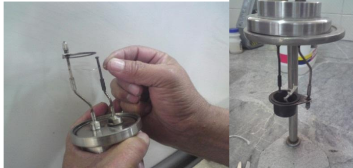
Figura 3.14. Alambre conductor para la quema de la muestra.
