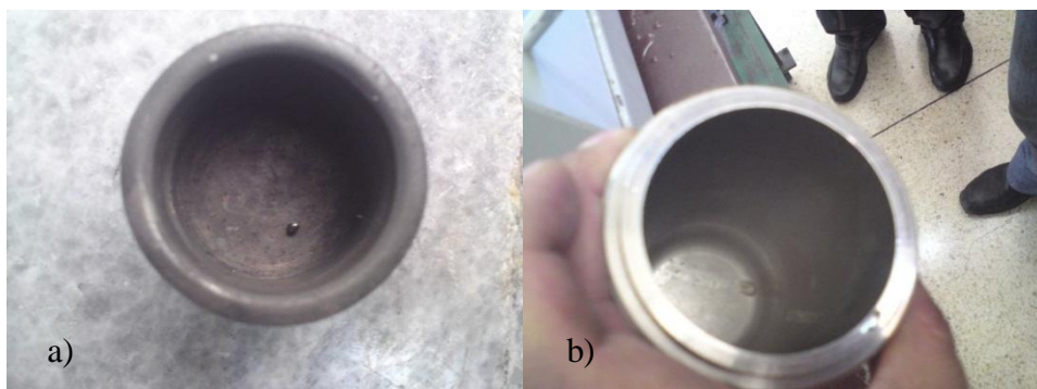
Figura 4.10. Quema completa del eucalipto sin humedad, obteniéndose el poder calórico superior. a) porta muestras; b) cilindro de la bomba calorimétrica libre de vapor.
