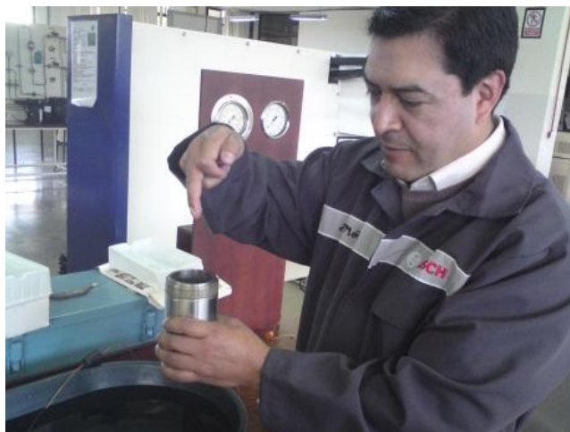
Figura 3.16. Colocación de una gota de agua en el interior de la bomba calorimétrica.
