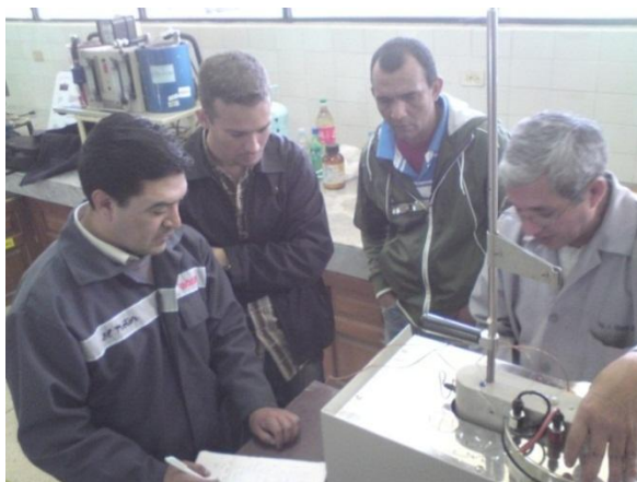
Figura 3.19. Registro de datos de la elevación de la temperatura durante la combustión.
