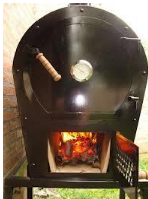
Figura 5.8. Modo de introducir la biomasa vegetal por el frente del horno y acomodándola a la izquierda y derecha de la base.
