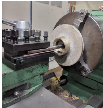
Figura 38. Impulsor en proceso de mecanizado
