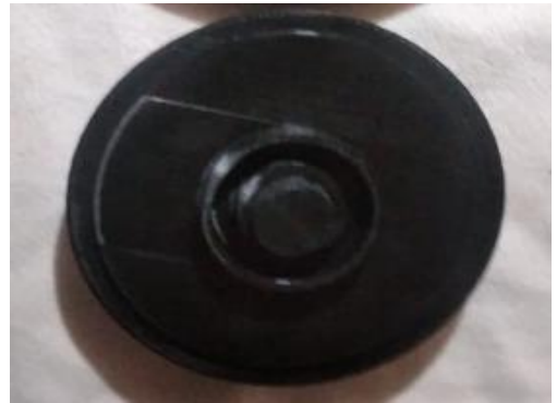
Tapa inferior para la fundición impresa en 3D.
