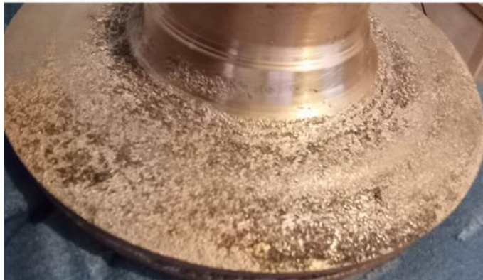
Figura 50. Rugosidad del impulsor fundido.
