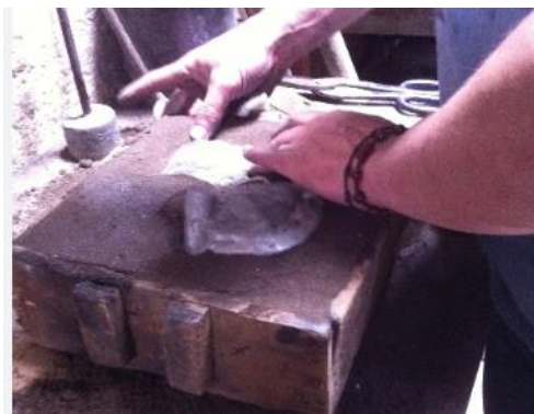
Figura 36. Remoción de la pieza fundida.
