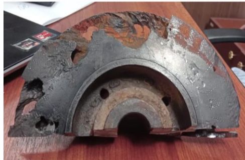
Figura 44. Desgastes del impulsor.
