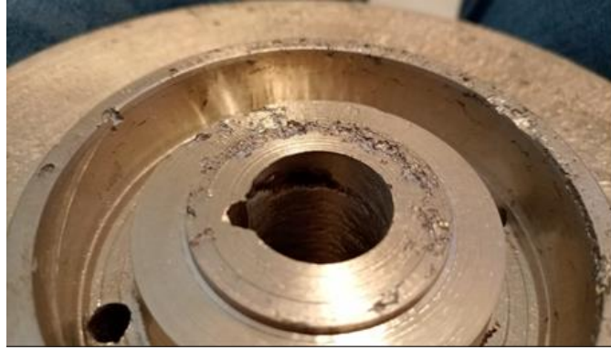
Figura 49. Grietas del impulsor fundido.
