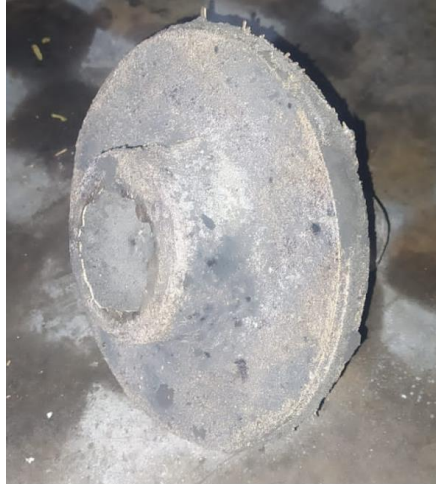
Figura 37. Impulsor fundido desmoldado.
