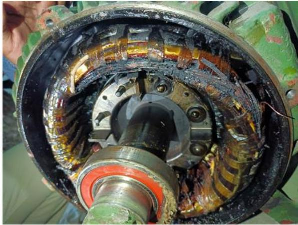
**ANEXO V:** Bomba en mal estado hilos de la bobina rotos.
