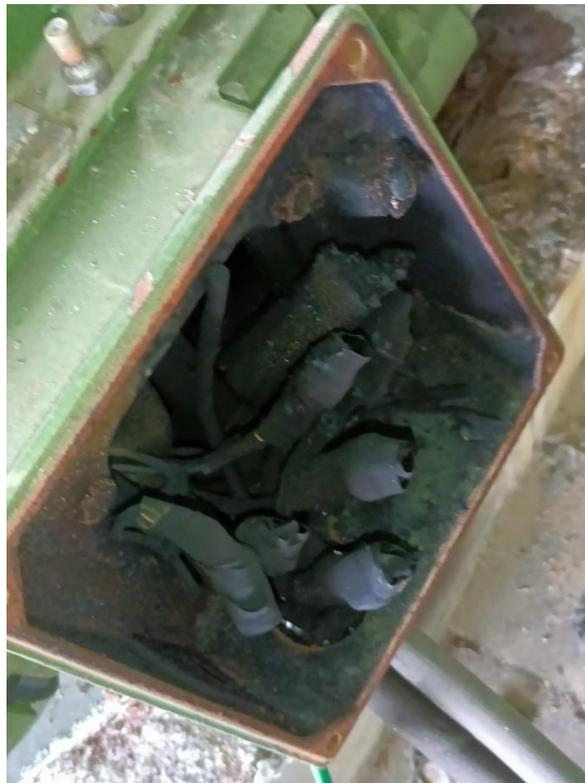
**ANEXO VI:** Cables de conexión quemados de la bomba.
