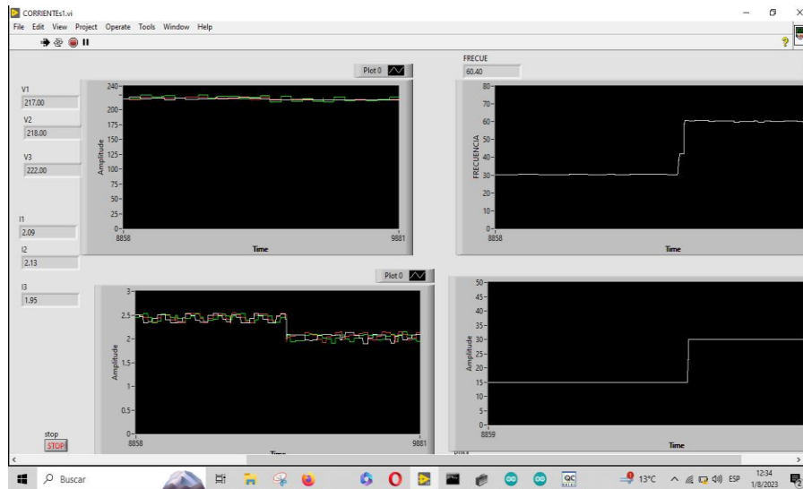
Figura 56 Curvas de los parámetros eléctricos con el usos de variador, setead a 60Hz
