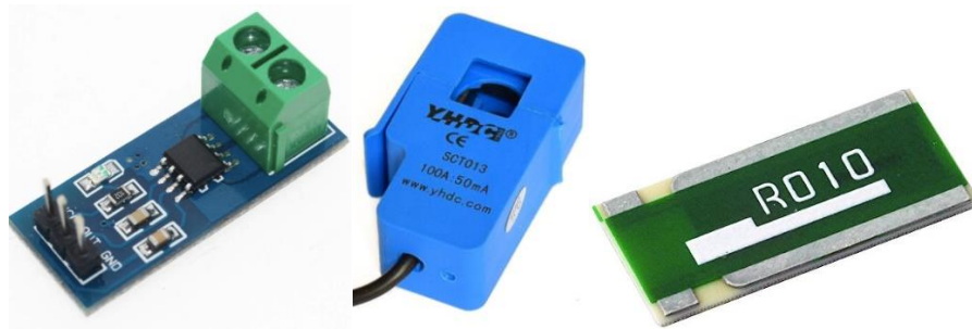
Figura 22 Sensores de corriente, sensor efecto hall, sensor transformador de corriente, resistencia de detección de corriente
