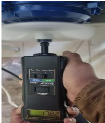
Figura 42 Dato de revoluciones del motor sin la caja reductora de velocidad
