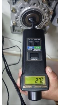
Figura 43 Dato de revoluciones del motor en la caja reductora de velocidad
