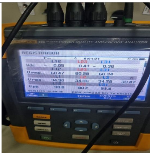
Figura 51 Analizador de redes fluke conectado al Sistema con un seteo de 15Hz
