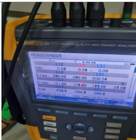
Figura 56 Curvas de los parámetros eléctricos con el usos de variador, setead a 60Hz
