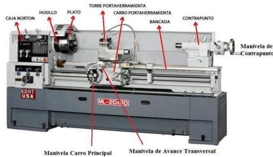
**Figura 2. 6.** Partes principales del torno
