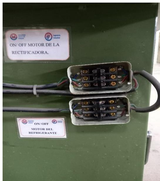
**Figura 3. 13.** Circuito de control de la afiladora de cuchillas
