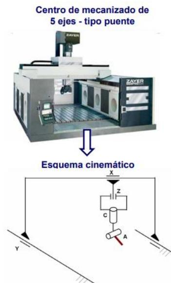
**Figura 2. 3.** Esquema cinemático de centro mecanizado de 5 ejes
