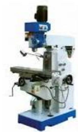
**Figura 2. 12.** Fresadora vertical
