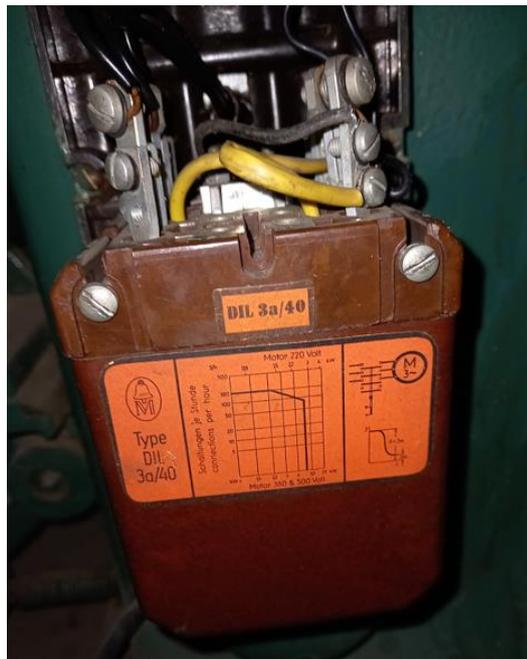
**Figura 3. 11.** Circuito de control de la cepilladora KLOPP
