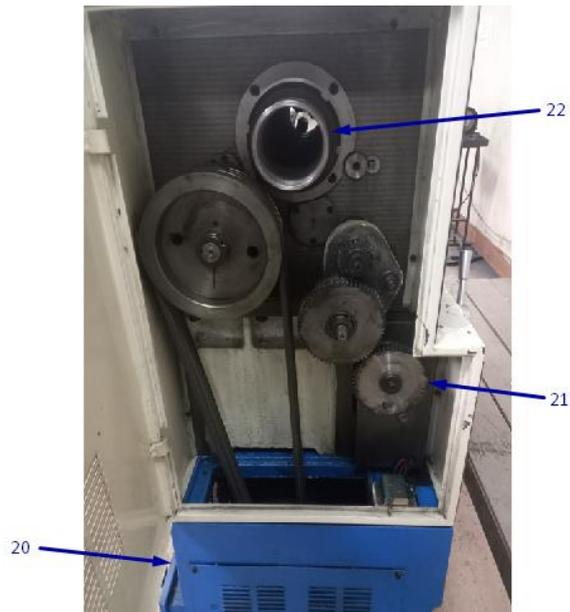
**Figura 3. 2.** Partes internas del sistema de transmisión del torno paralelo
