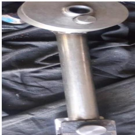
Figura 3.4: Mecanizado de la biela
