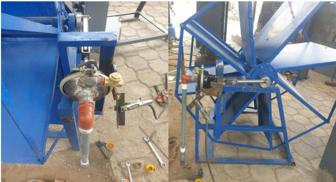
Anexo 7.9: Ensamble del sistema de bombeo a la rueda hidráulica
