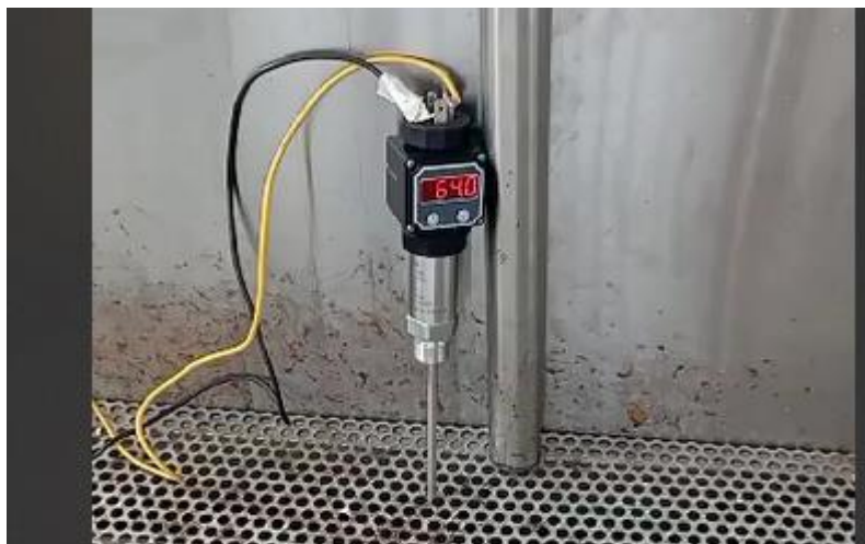
Figura 3.12: Sensor de temperatura para calibración de sensores.
