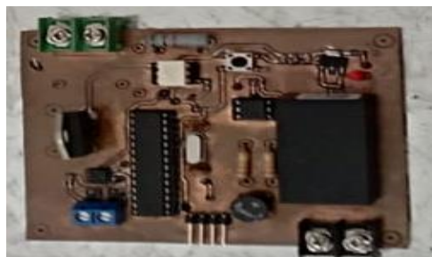
Figura 3.5: Circuito de control de fase
