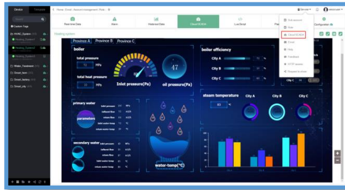
Figura 2.4: Configuración de un SCADA en la nube.
