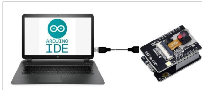
Fig. 17. Conexión de la ESP32-CAM con el computador
