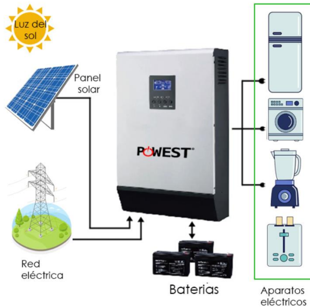
Figura 4.3. Esquema del sistema de almacenamiento ONGRID [31].
