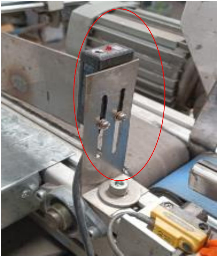
Figura XV.34: Montaje del acoplamiento para el sensor autorefectivo 1
