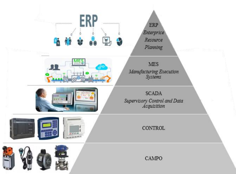
Figura 2.1: Pirámide de la automatización
