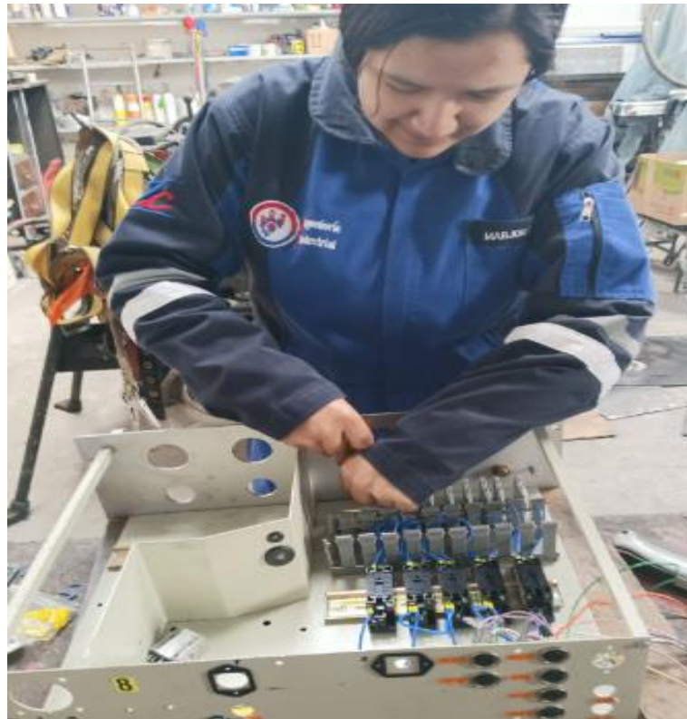
Figura XIX.49: Montaje elementos eléctricos
