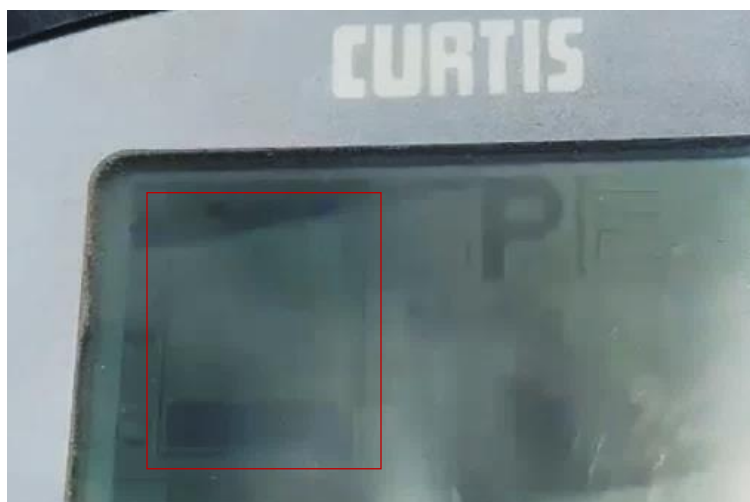
Figura 3.69. Momento el cual se emite el agotamiento de la batería, activando de manera automática la reserva.
