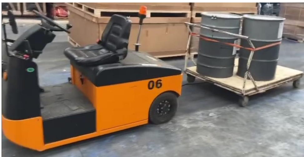
Figura 3.66. Coche eléctrico anclado al prototipo del remolque el que transporta 2 tanques de sellante.
