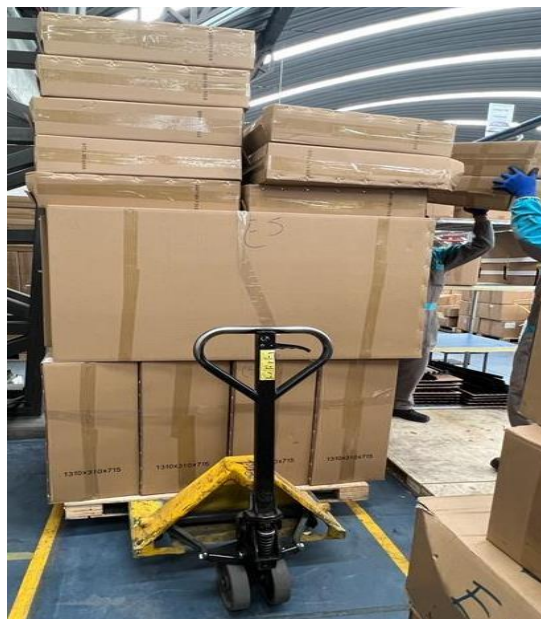
Figura 3.8. Tras pallet con componentes que están encima del pallet con una altura de 2.35m
