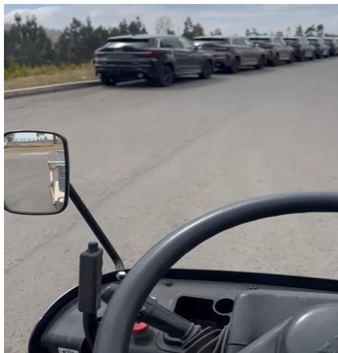
Figura 3.68. Pruebas midiendo la durabilidad del coche, con arrastre de carga de 450Kg a 850kg, durante un tiempo continuo.
