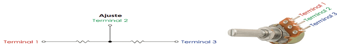
Figura 28. Características de un potenciómetro
