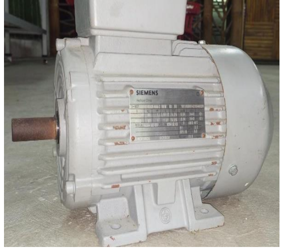
Imagen 8: Motor trifásico de 1HP marca SIEMENS
