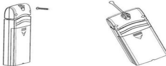
Figura 5: Montaje del sensor interior
